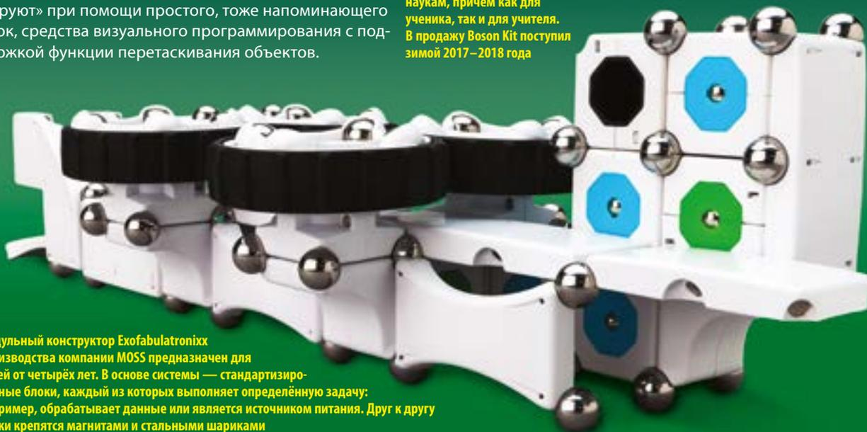
Модульный конструктор **Exofabulatronix** производства компании **MOSS** предназначен для детей от четырёх лет. В основе системы — стандартизированные блоки, каждый из которых выполняет определённую задачу: например, обрабатывает данные или является источником питания. Друг к другу блоки крепятся магнитами и стальными шариками
