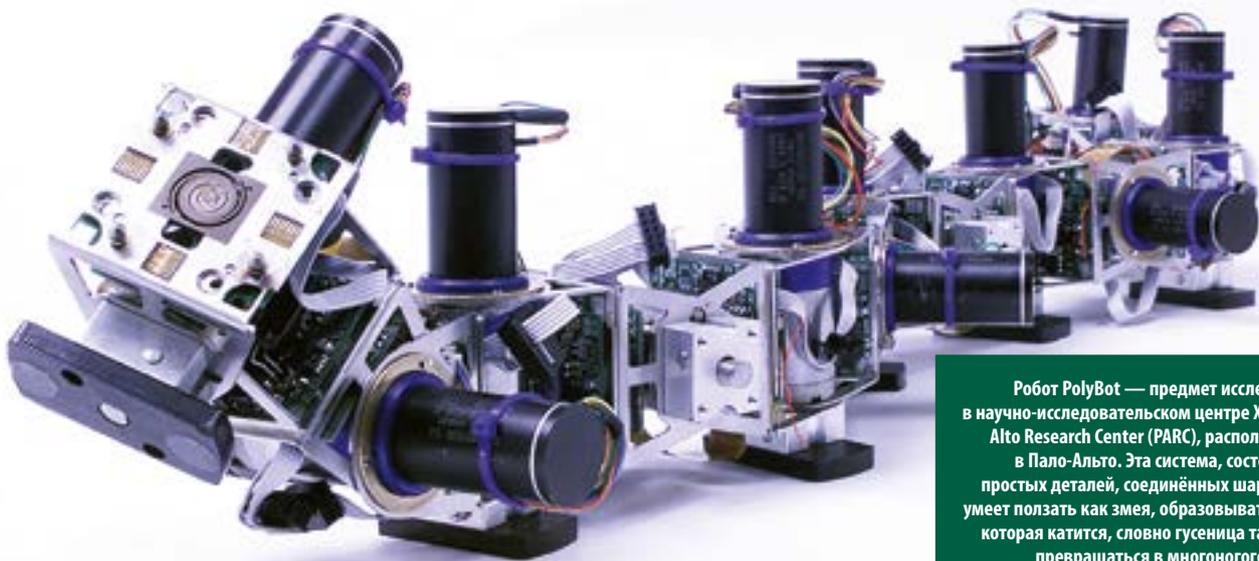
Робот PolyBot — предмет исследований в научно-исследовательском центре Xerox Palo Alto Research Center (PARC), расположенном в Пало-Альто. Эта система, состоящая из простых деталей, соединённых шарнирами, умеет ползать как змея, образовывать петлю, которая катится, словно гусеница танка, или превращаться в многоногого «паука»
